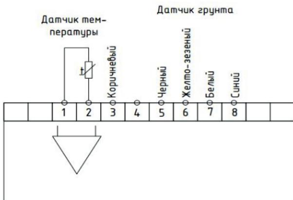
Замерьте сопротивление между Коричневым проводом и переменно Желто Зеленым и Черным, сопротивление между найденными контактами составит примерно 10 кОм (при температуре 25°C), прозвонившийся провод будет желто зеленым (6 контакт), оставшийся черный (5 контакт).
