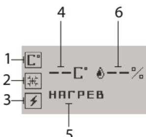
Рис. 5 Если датчик отключен, его символ отображается инверсно.
