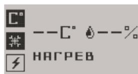
Текущее значение температуры отображается на экране (4) во второй строке. Рядом – текущее значение датчика осадков (6). После срабатывания системы электрообогрева, когда температура выйдет за пределы установленного диапазона и/или уровень осадков опустится ниже установленного значения, система электрообогрева перейдет в режим догрева, длительность догрева задается в меню. После истечения времени догрева питание нагревающего контура отключается.
