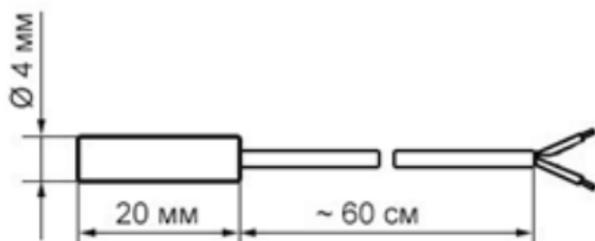
Рис. 3 Габариты датчика осадков
