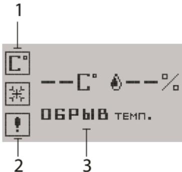
При возникновении нештатной ситуации, на экране отображается мигающий символ аварийного режима, реле «Авария» срабатывает (2).
