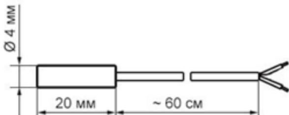
Рис. 3 Габариты датчика осадков
