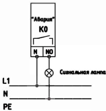
Рис. 16 - сигнальная лампа не горит, индикация режима аварии происходит при возникновении аварийной ситуации. Цепь сигнализации замыкается, сигнальная лампа загорается.
